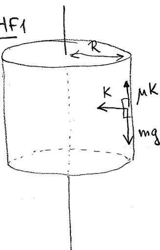
a.) feltörjük a műrelégtettség függőleges és radialis komponensét;  $z = \text{áll.}$   $r = \text{áll.}$
